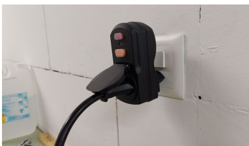
Figura 4: RCD mobile da 30 mA (fonte Electrosuisse)
