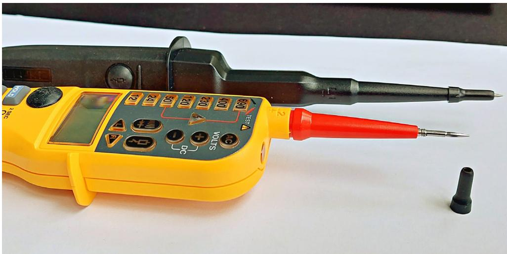
Bild 15: Messspitzen 4 mm
