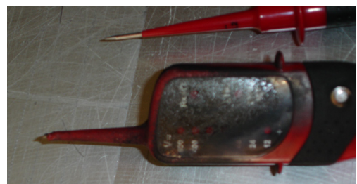
Bild 3: Messinstrument nach Kurzschluss
